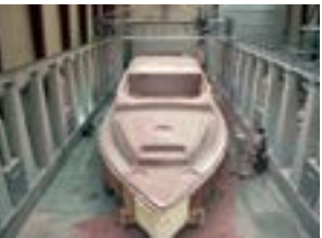
Pièce d'un pont de bateau avec une surface homogène, sans joint et lisse.
