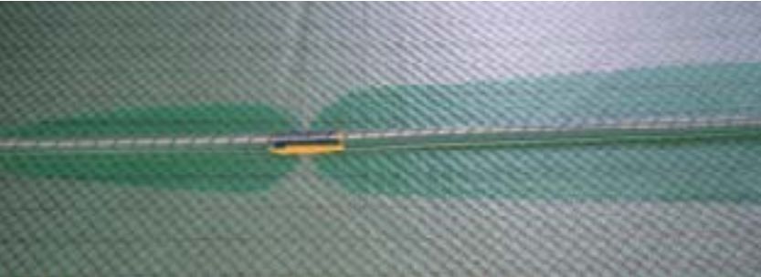
Vacuuminfusion d'une lame de vent avec Biresin® CR131.
