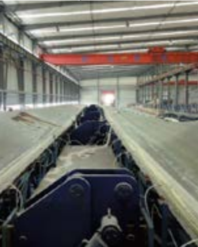
Vacuuminfusion d'une lame de vent avec Biresin® CR131.
